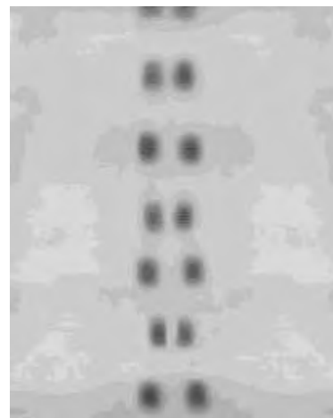
Рис. 2. Траектории движения двух капель магнитной жидкости в переменном магнитном поле, когда направление движения капель перпендикулярно направлению напряженности магнитного поля.
