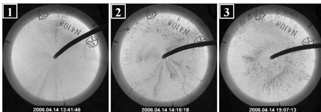
Рис. 6. Изменение структуры течения в радиально – расширяющемся потоке при постоянно действующем перепаде давления \Delta p = 0,2 \text{ МПа} (цифры 1, 2, 3 соответствуют моментам времени, указанным на рис.5 – 21, 56 и 107 минут от начала нагнетания).
